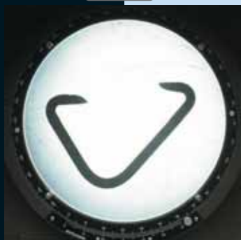
Badanie geometrii połączenia przy pomocy rzutnika profilu
