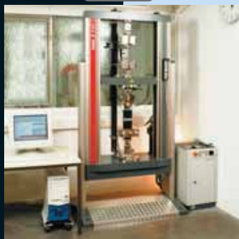
Badanie surowców i wyrobów przy pomocy nowoczesnej maszyny wytrzymałościowej
